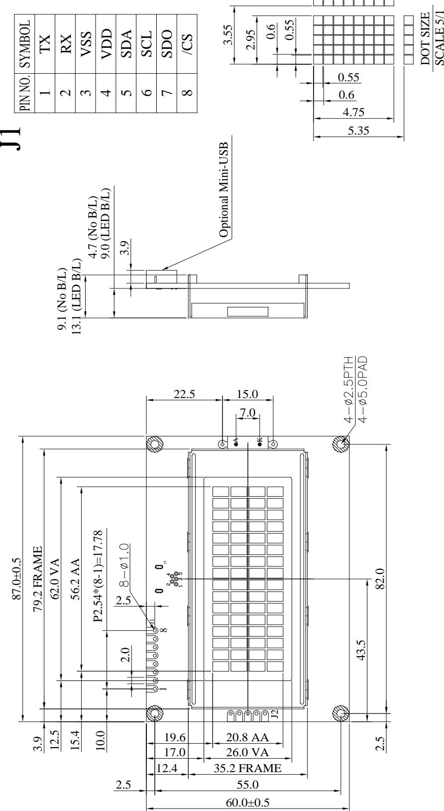
THE NON-SPECIFIED TOLERANCE OF DIMENSION IS $\pm$ 0.3mm
